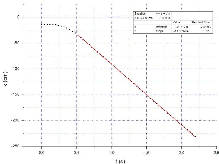
Per tempi maggiori di 0,56 s abbiamo un andamento lineare dei dati raccolti: il carrello si muove a velocità costante. Interpoliamo (via software) i punti con una retta  $y=a+bx$ :
